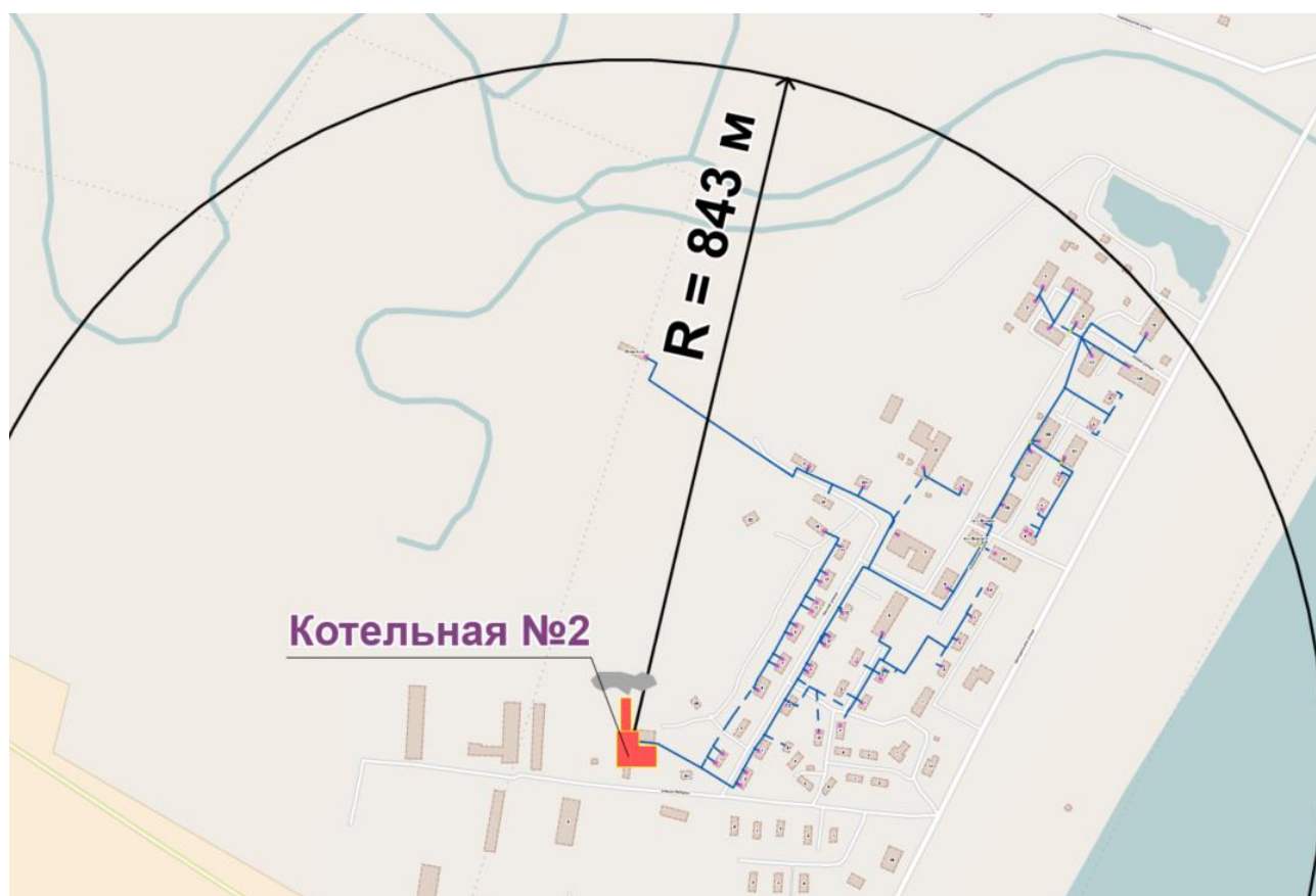
Рисунок 13. Радиус эффективного теплоснабжения котельной №2
